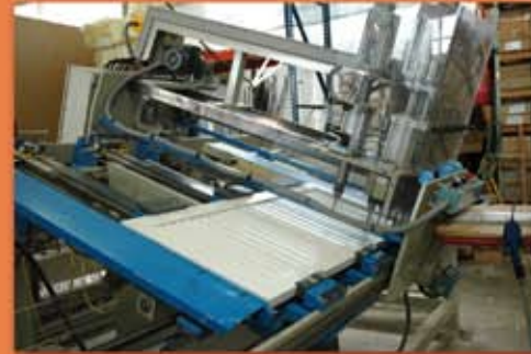
Le perçage automatisé du Ferrage
